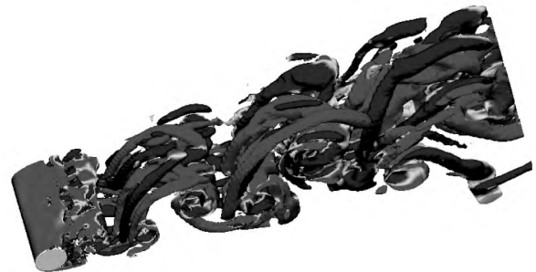
图 11 瞬时的三维涡量等值面图 ( Q=100 )
