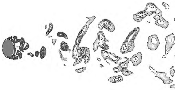
图 10 xoy (z = \pi D/2) 平面处涡量等值线图
