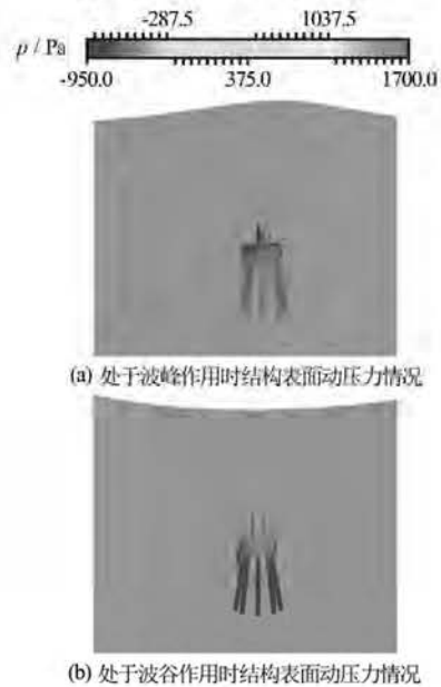
图 8 基础表面动压力情况 Fig.8 Illustration of free surface
