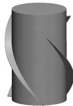
图 1 Spar 硬舱部分模型示意图 Fig.1 Spar geometry with helical strakes
