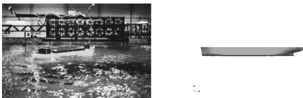
图 1 FPSO 实验模型与数值模型
