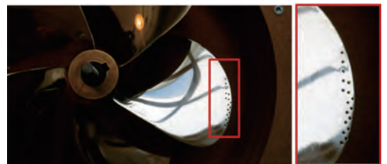
(b) 螺旋桨叶梢开孔示意图
