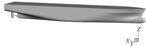
图1 KCS 三维模型 Fig.1 3D model of KCS
