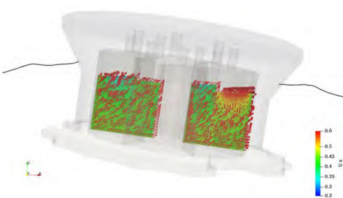
图6-22 187.7s 时圆筒型 FPSO 舱内纵截面 X 方向速度云图和流速矢量图 (单位: m/s)
