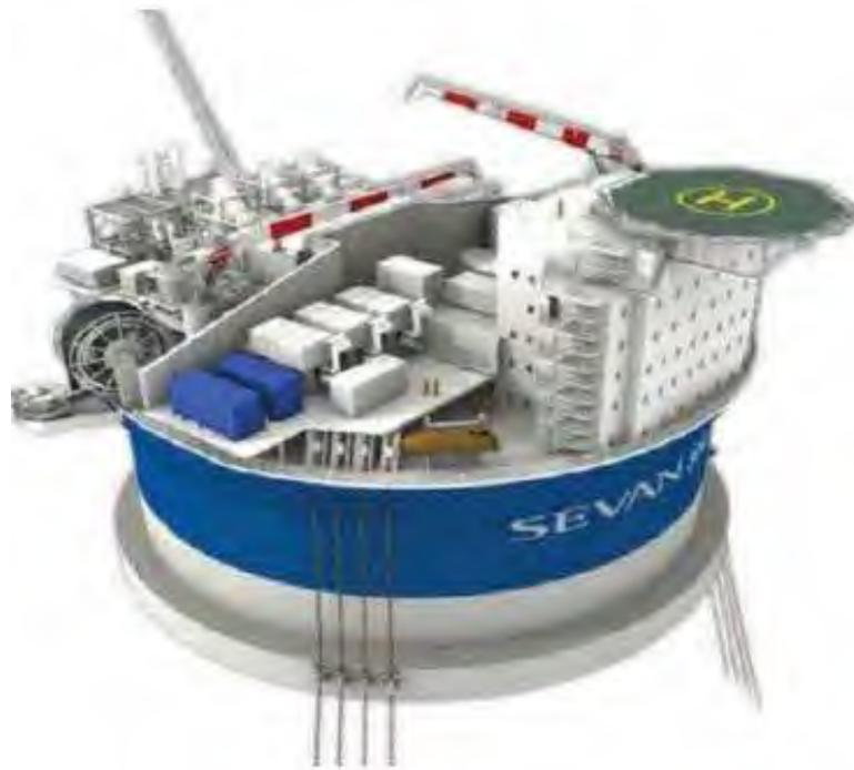
图1-3 圆筒型 FPSO<sup>[4]</sup>
