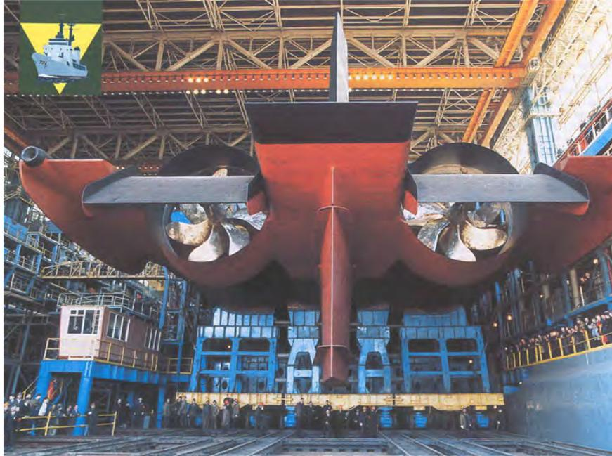
图 1-9 导管螺旋桨
