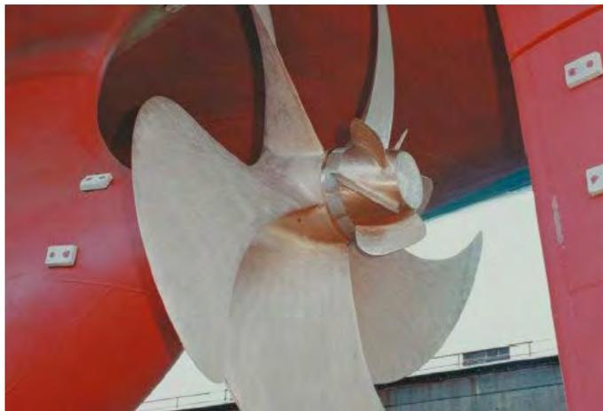
图 1 - 13 安装于实船的毂帽鳍<sup>[5]</sup>
