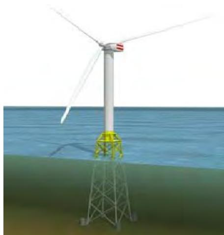
图 1-7 海上风机导管架基础示意图
