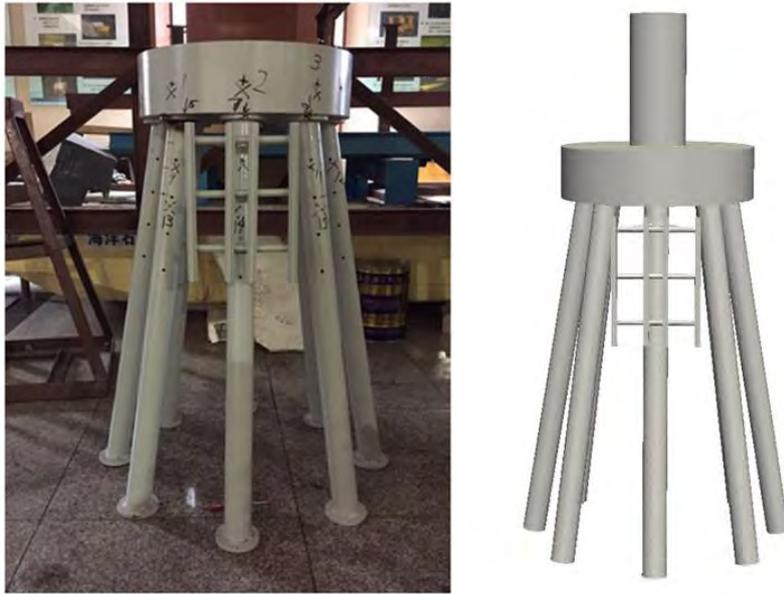
图 4-1 试验模型（左）与数值模型（右）
