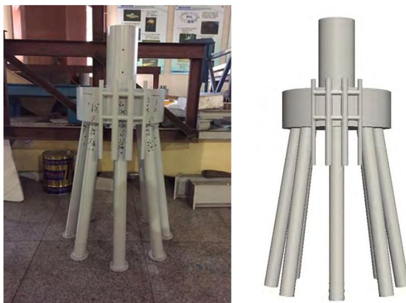
图 5-1 试验模型（左）与数值模型（右）
