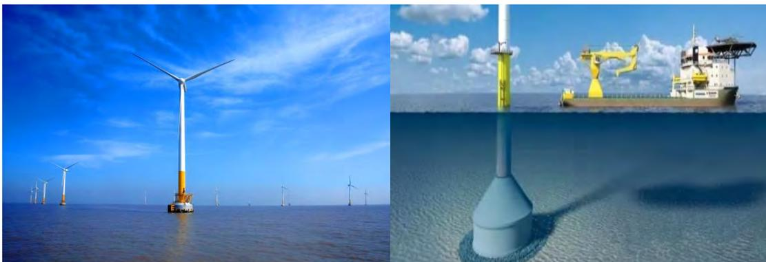
图 1-5 海上风机重力式基础示意图
