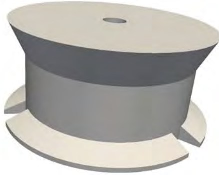
图 1-17 圆筒形 FPSO 数值计算模型图
