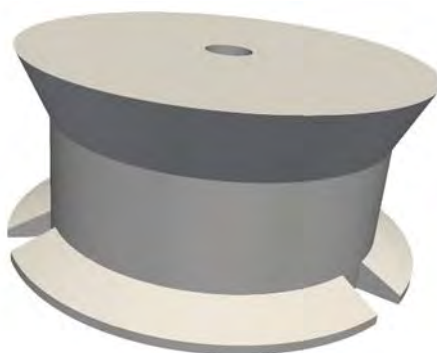
图 4-1 圆筒形 FPSO 数值计算模型图 (M0)
