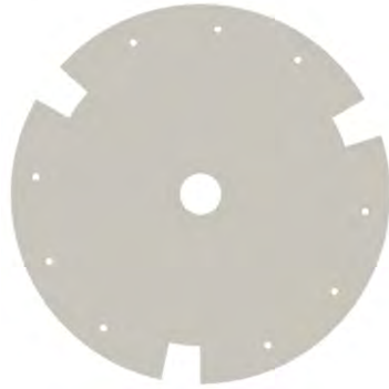
图 4-6 阻尼结构底部开孔示意 (M1)
