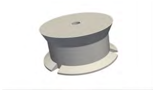
图 3-1 圆筒形 FPSO 数值计算模型图
