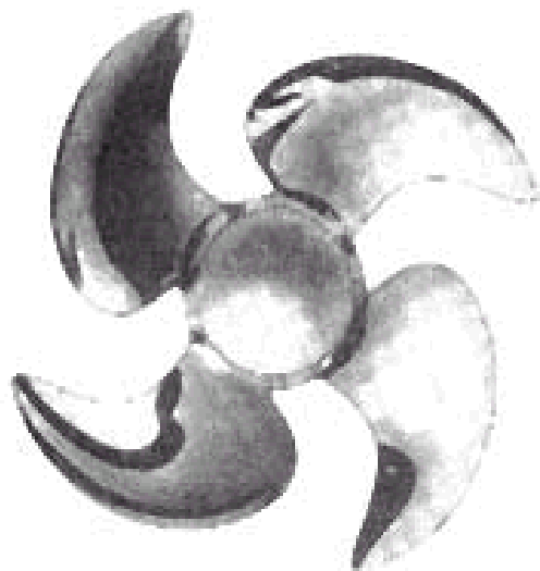
用于车客渡船的大侧斜螺旋桨 (直径5.1米, 主机功率21250马力, 船速23.2节)
