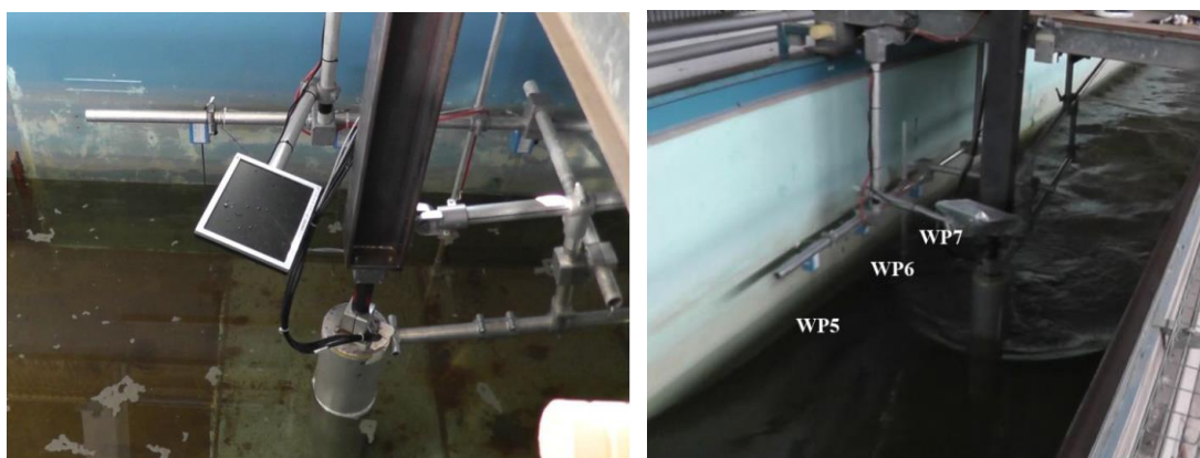
图 1-5 圆柱与聚焦波相互作用的实验设置
