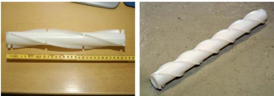
图 1-5 带螺旋侧板立管<sup>[18]</sup>
