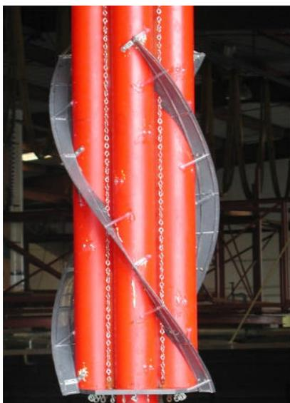
图1-2 带螺旋侧板的 Cell Spar 模型 (Finn, L.D. et al., 2003)
