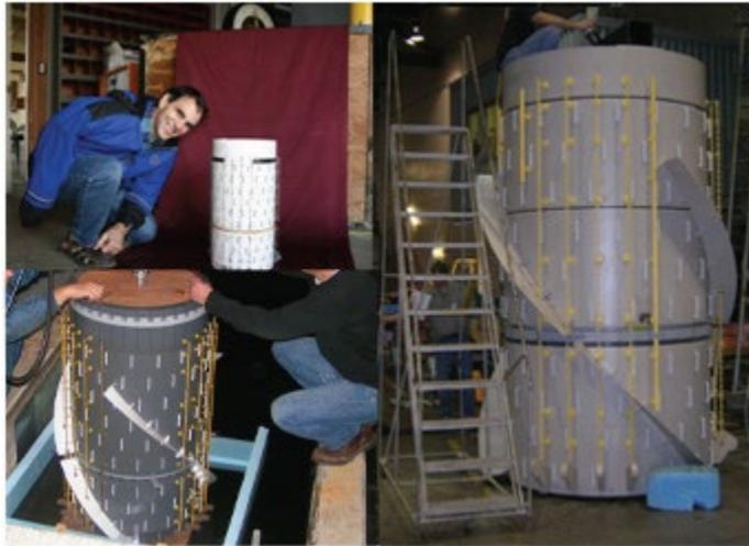
图1-3 三个不同缩尺比的 Spar 模型 (Roddier, D. et al., 2009)
