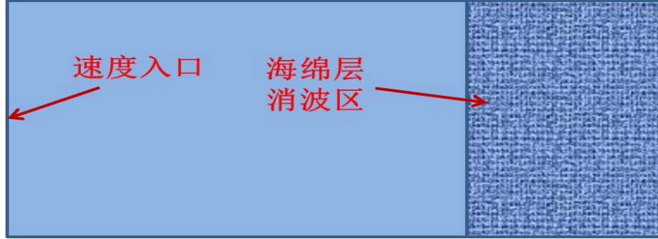
图 2-9 数值造波边界与海绵层消波区示意图
