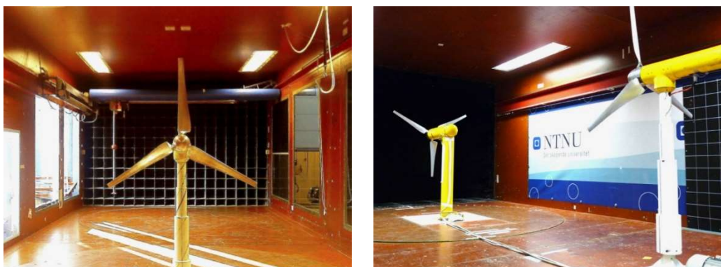
图 3-1 Blind Test 3 风洞示意图 Fig. 3- 1 Layout of Blind test 3 wind tunnel
