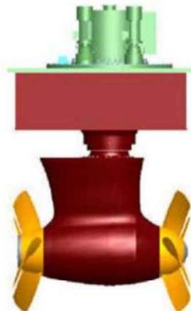
图 1-4 对转型吊舱推进器
