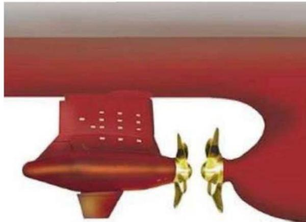
图 1-7 混合式 CRP 吊舱推进器布置图
