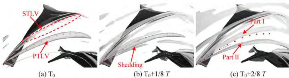
图 1-3 叶轮转动周期内 TLV 的不稳定演化(截取前 3 个时间步) [55]
