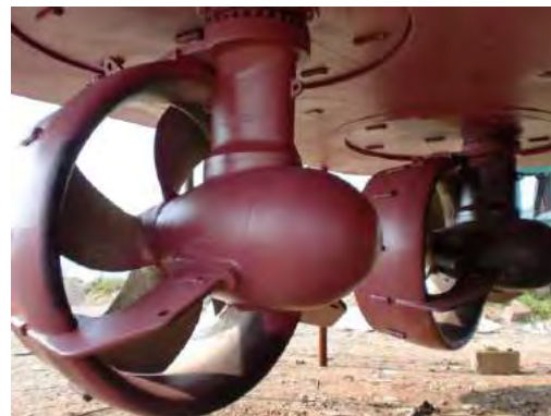
图 1-1 导管桨船体安装实物图 [4]
