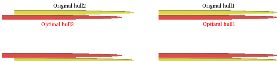
图 5-8 优化方案（红色）与原始方案（黄色）片体布局对比
