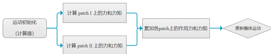
图 2-3 液舱内外壁力矩输出流程图
