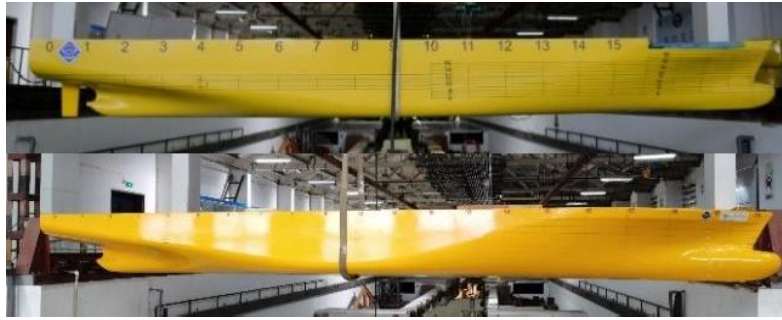
图1 上图：小模型的KCS船C2724；下图：大模型的KCS船C2954
